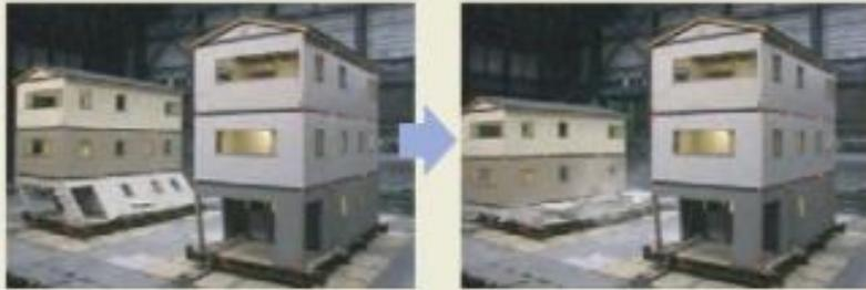
3階建て実大木造住宅の振動台実験 ※1
